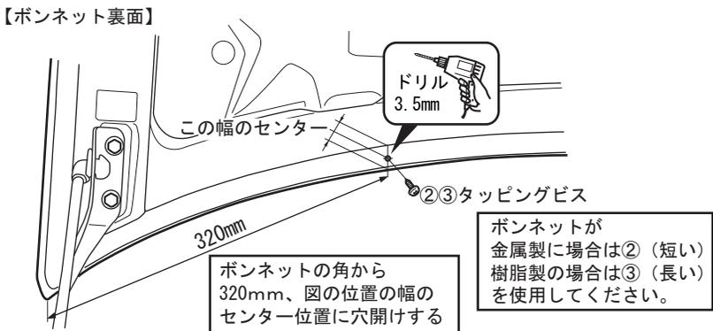
5. 穴開け位置をボンネットが金属製の場合は②タッピングビス(短い)にて、樹脂製の場合は③タッピングビス(長い)を使用して締め過ぎに注意しながら、固定してください。
