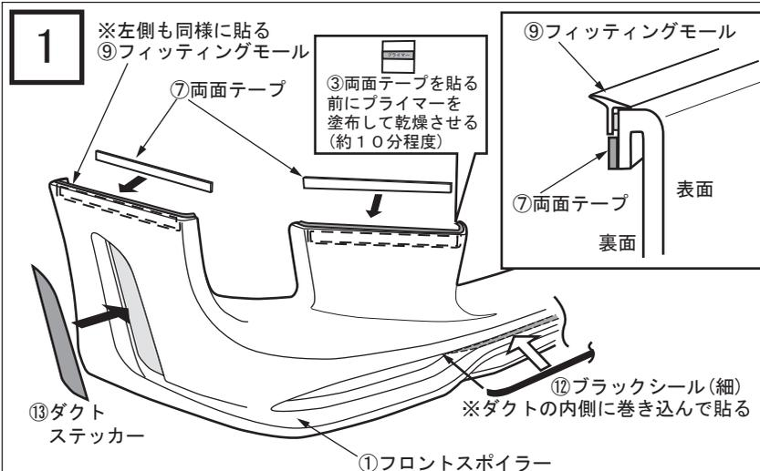
1. 図を参考にして、①フロントスポイラー裏面及び車両の両面テープ貼り付け部分を十分に脱脂して①フロントスポイラー裏面の⑦両面テープ貼付部に⑧プライマーを塗布して乾燥してください。(約10分程度)
